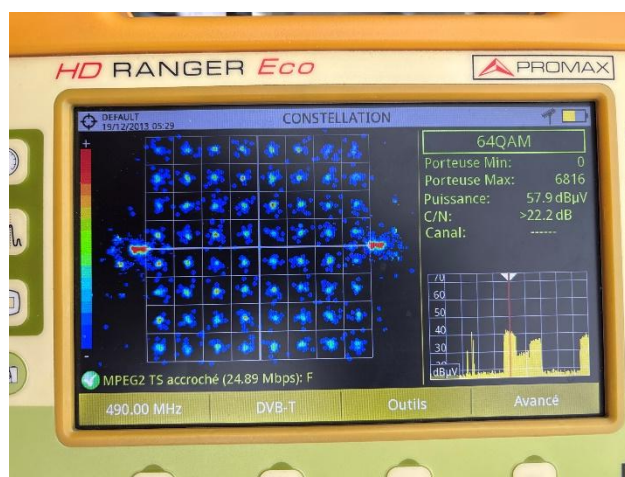
Figure 2 : Exemple d'analyse de constellation sur mesureur de champ.
